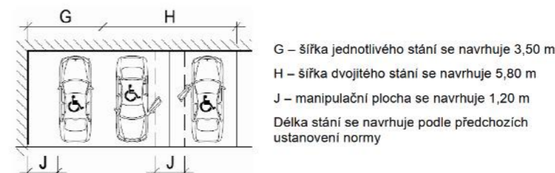
Obrázek 7 – Prostorové uspořádání parkovacích stání s kolmým řazením pro vozidla přepravující osoby těžce pohybově postižené
